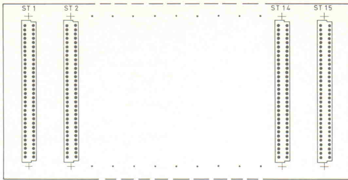
Bild 23. Will man wie beim Prototyp nur mit 50-mm-Frontplatten arbeiten, reicht es, nur jeden zweiten Steckplatz mit einer VG-Leiste zu versehen.
